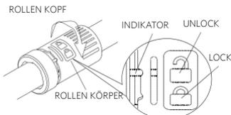
Greifen Sie den Rollenkörper und Rollenkopf und drehen in die entriegelte Position.
